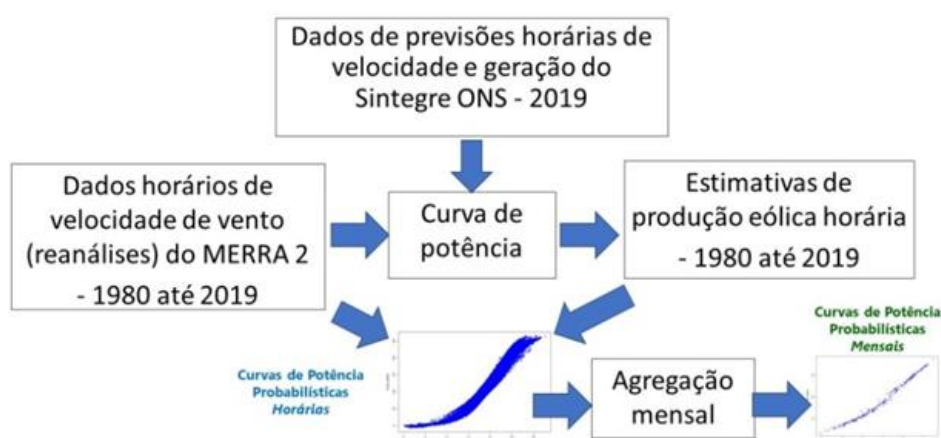
Figura 5.1 - Procedimento para a obtenção de Curvas de Potência Probabilísticas Mensais utilizando dados do SINTEGRE e MERRA 2 – Diagrama Esquemático
